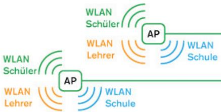
Im Schaubild sind die zwei WLAN Access Points in drei Netzen vertreten. Die Aufgabe der WLAN Access Points ist es nun, diese Netze voneinander zu isolieren und alle Daten dieser Netze nur zur OctoGate Schufirewall zu transportieren. Diese entscheidet dann, ob die Netzwerkanfrage des betreffenden Users bearbeitet werden darf oder abgelehnt wird.
