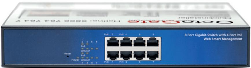
Die zentrale Anschaffung eines PoE-fähigen Switches hat einen weiteren Vorteil: Man kann zeitgesteuert oder per Software sämtliche WLAN Access Points ein- oder ausschalten. Das spart zusätzlich Energie.
